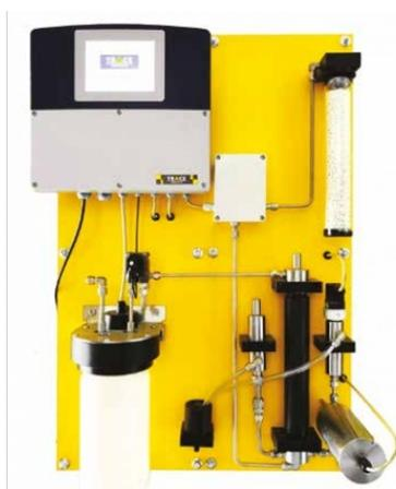
Le spécialiste de l'analyse de l'eau Trace Analysis a notamment développé, avec un partenaire allemand, des analyseurs en ligne pour la conductivité (Multicon DCC ; photographie) et le chlore (Hydroly/ Hydrolyt QC). Photo : Trace Analysis
