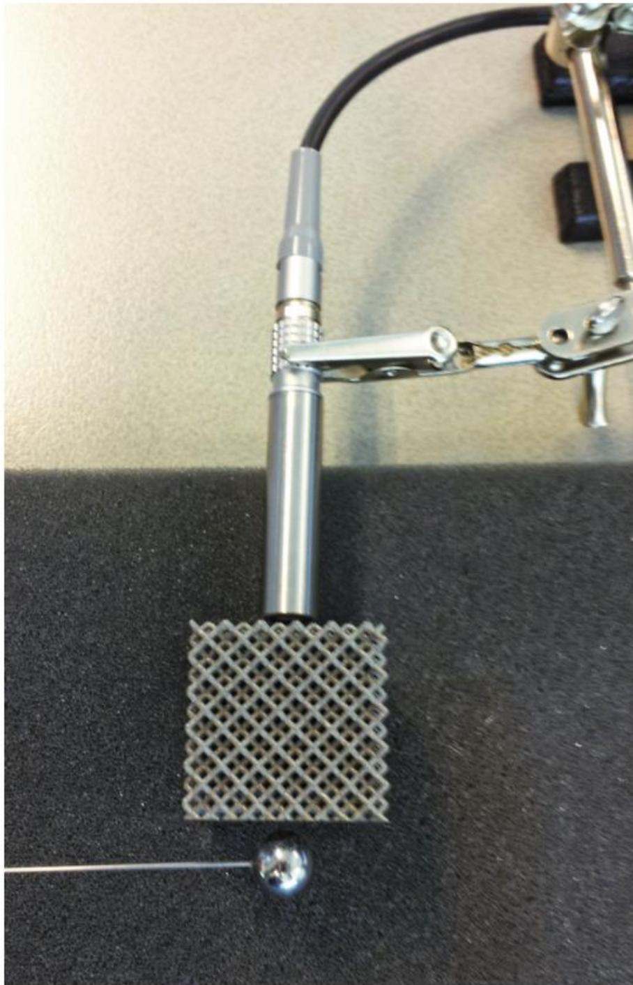
*Le LNE mène des recherches sur la spectroscopie par résonance acoustique pour l'inspection de routine.*
