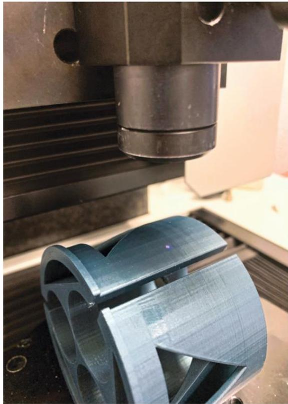
La mesure confocale chromatique peut être utilisée en cours de production.
