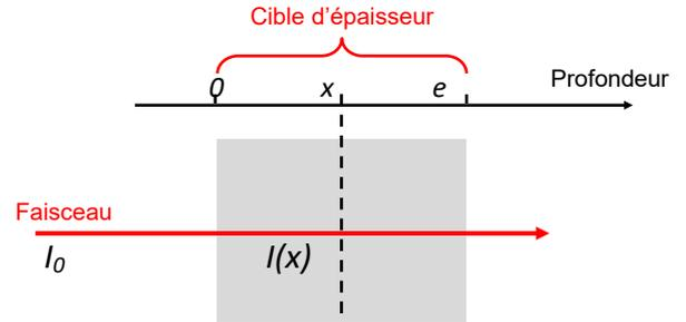
L'atténuation de l'amplitude de l'onde TeraHertz, à travers un matériau, est influencée par plusieurs phénomènes d'interaction: réflexion à chaque interface, diffusion et absorption interne. Les hétérogénéités locales du matériau créent des variations d'amplitude de l'onde transmise en fonction de leurs types et de leurs dimensions.
