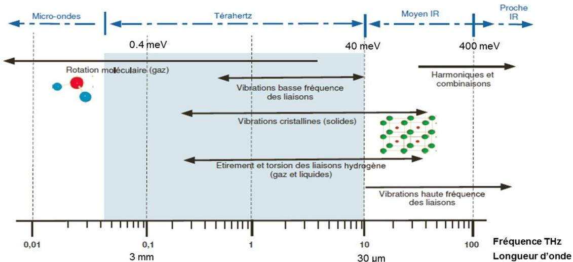
Selon la fréquence, l'onde TeraHertz interagit avec la matière en fonction des différents modes d'excitation décrits dans le graphique ci-dessus ; le niveau des valeurs de l'onde absorbée ou réfléchié indique les propriétés structurales de la matière, telles que la cristallinité, affichées dans le graphique à droite.
