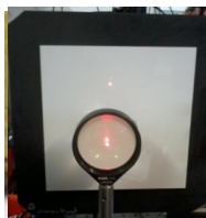
Contrôle d'un assemblage collé polymère-composite
